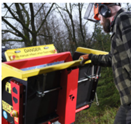
Eenvoudige bediening van de versterkte heavy-duty trechter dankzij gasveer
