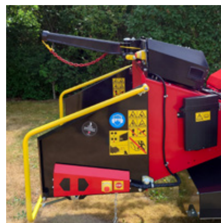
Een hydraulische lier is een optie voor alle TP 215 mobiele en rupsbandmodellen
