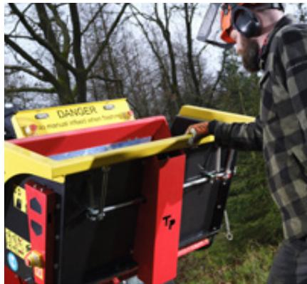
Manipulation facile de l'entonnoir renforcé et robuste grâce au ressort à gaz
