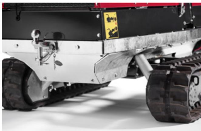
Garde au sol de 200 mm, entretien facile et protection renforcée du tuyau. Largeur de chenilles variable 1150 à 1350 mm
