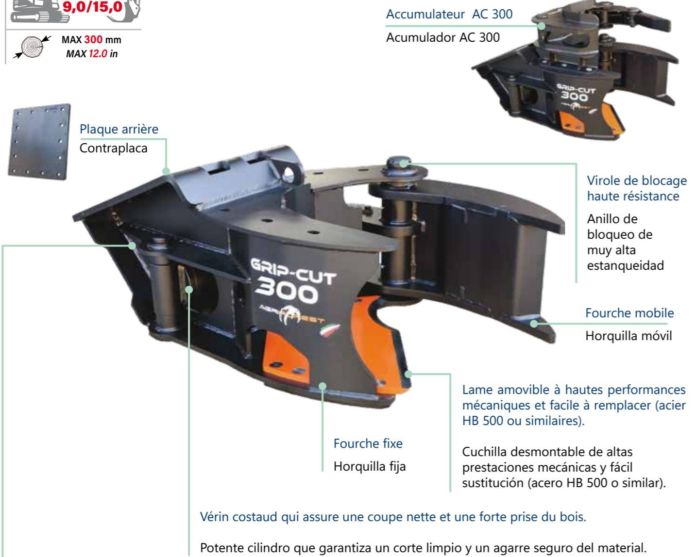
Construit avec des matériaux de première qualité tels que des aciers en S 700, des axes en acier 39NiCrMo3, des bagues bronzées à l'intérieur pour garantir des performances optimales et une longue tenue.
