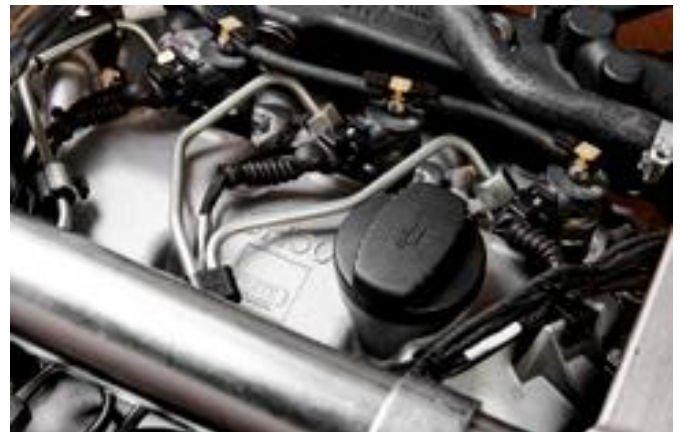
Hatz motor uit Duitsland, stage V met Bosch common rail systeem
