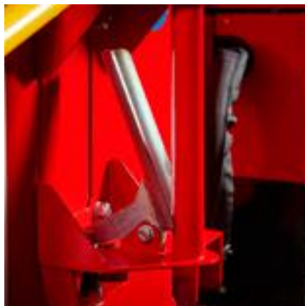
Ergonomisch ontwerp met eenvoudige handgreep voor het snel en veilig draaien van de versnipperaar
