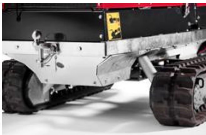
Bodemvrijheid van 200 mm, eenvoudig onderhoud en versterkte slangbescherming. Variabele breedte 115-135 mm
