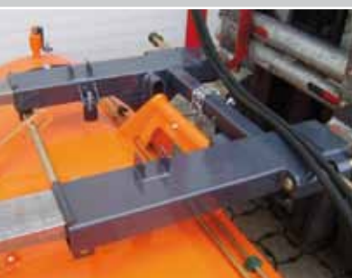
Standaard 3D-niveaucompensatie van het aankoppelsysteem
