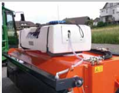
Watersproeinrichting met 100- of 200- liter tank
