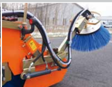
Hydraulisch opklapbare zijbezem
