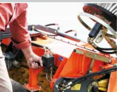
Toerentalinstelling van de zijbezem
