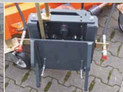
Aankoppeling voor wiellader met niveauregeling
