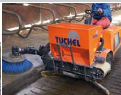
Roosters schoon schuiven – boxen uitvegen en instrooien in één werkgang
