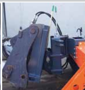
Rollenbaan met hoogteaanwijzing en pendeladapter
