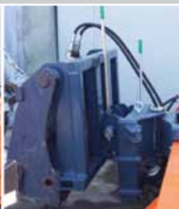
Rollenbaan met hoogteaanwijzing en pendeladapter
