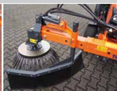
Schuinverstelling met hydraulische aanpassing hellingshoek
