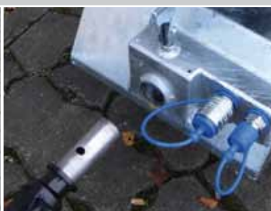
Snelwisselaanbouw met dubbelwerkende ventiel standaard
