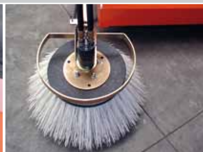
Zijbezem wordt hydraulisch aangedreven
