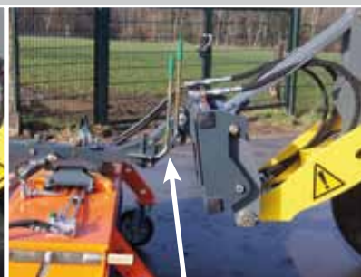
Wielladeraanbouw met parallellogram, en pendelcompensatie en hoogteaanwijzing
