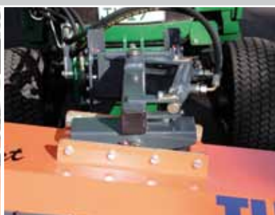
Niveauregeling met hydraulische schuinverstelling
