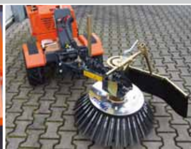
Onkruidborstel \varnothing 750 mm
