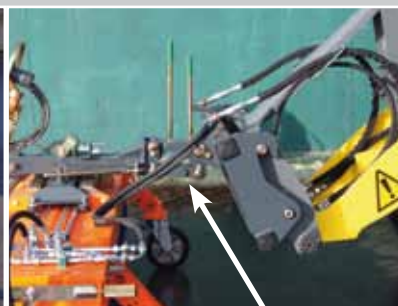
Wielladeraanbouw met parallellogram, en pendelcompensatie en hoogteaanwijzing
