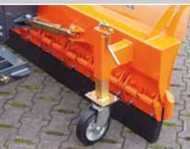
Traploos in hoogte verstelbare steunwielen
