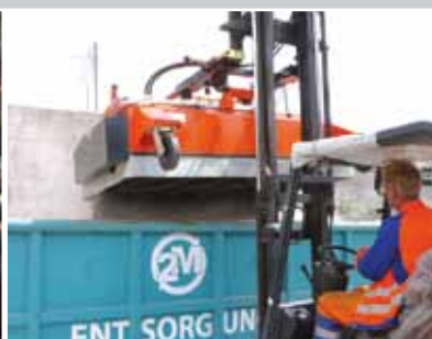
Hydraulische lediging van de opvangbak (standaard)
