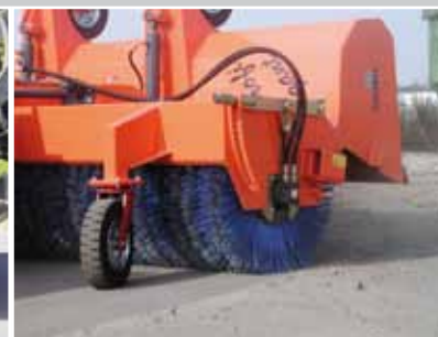
Eenvoudige borstelinstelling met het hevelsysteem
