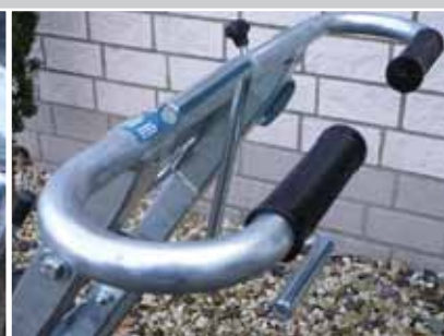
verstelbare stuurbeugel met hendel voor vooruit en achteruit
