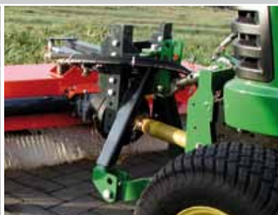
Mechanische aandrijving voor toerentallen van 540 tot 2100 toeren/min
