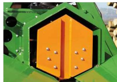
La plaque de pression puissante glisse de manière précise vers le couteau de fendage avec une puissance de fendage de jusqu'à 55 t.
