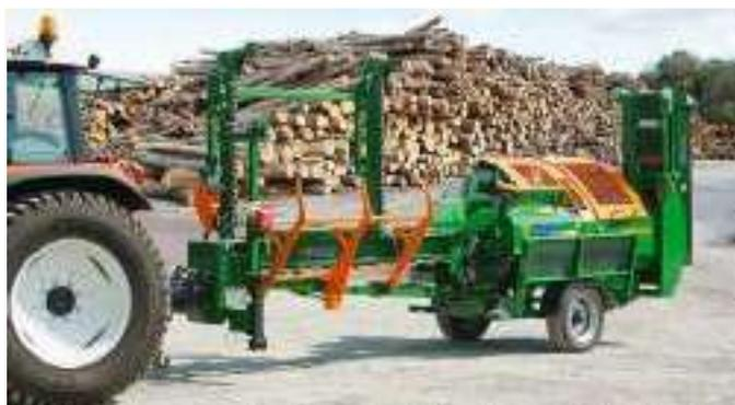
**Le châssis à remorquage longitudinal amène le SpaltFix sur les routes**
