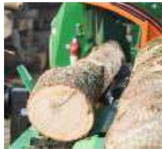
L'alimentation des grumes s'effectue au moyen d'une bande convoyeuse de 2 m de long. Avec le convoyeur à chaîne longitudinal mobile en option, le flux de travail devient encore plus efficace.
