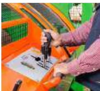
Dès que la grume est positionnée dans la machine, le fendage peut être commandé aisément et en toute sécurité via la manette.
