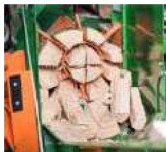
Selon le type de couteau de fendage utilisé, on peut obtenir 4, 6, 8 ou 12 bûches par opération. Le couteau est facile à changer à l'aide d'un treuil manuel (en option).
