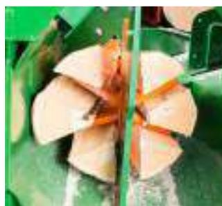
Grâce à Autospeed, le SpaltFix sélectionne automatiquement la vitesse d'avance optimale. Il coupe, fend et charge le bois en une seule opération.
