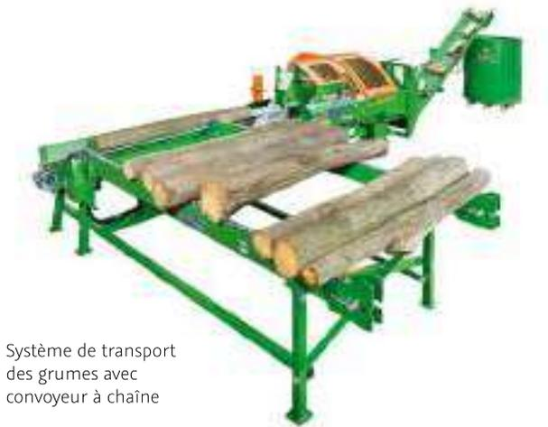
Système de transport des grumes avec convoyeur à chaîne
