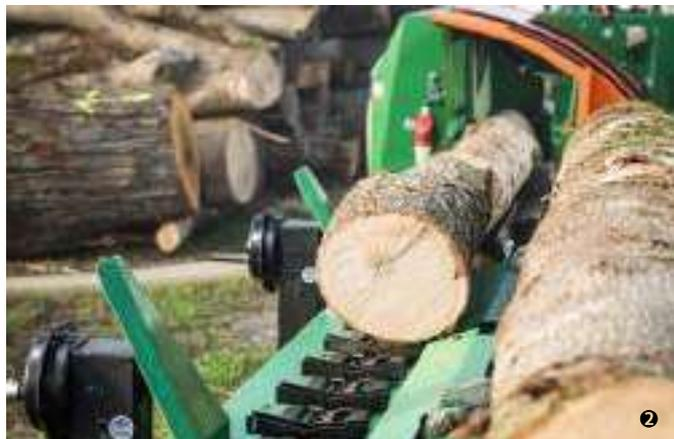
Chargement continu au moyen du système de transport des grumes, composé ① d'un convoyeur transversal et ② d'un convoyeur longitudinal.
