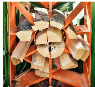
Le couteau à cadre carré MULTI, à réglage hydraulique, peut être facilement adapté au diamètre de la grume, et est capable de produire 2, 6 ou 12 bûches par opération, sans devoir changer de lame.
