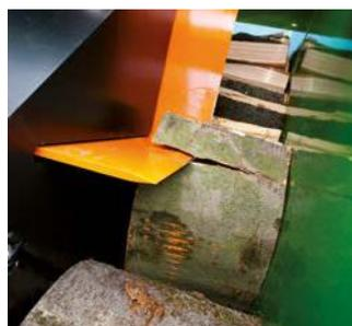
L'AutoSplit fend automatiquement la grume avec une puissance de fendage de 16 t et un couteau de fendage en forme de X. L'avance réglable en continu permet de déterminer avec précision la taille des bûches avec une longueur d'arête de 5 à 15 cm.
