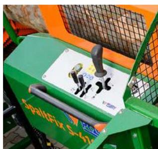
Du conditionnement à la coupe des bûches, l'opérateur peut contrôler tous les processus de manière centralisée. Grâce au bras de centrage disponible en option, les bûches tordues peuvent être mieux positionnées.
