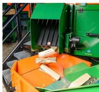
Avec un bois de chauffage de 12–33 cm de long, la longueur d'arête des bûches peut être réglée entre 4–15 cm. Pour obtenir un bois d'allumage parfait d'une longueur maximale de 20 cm, il est possible de produire des bûches plus fines. Disponible sur demande : AutoSplit 650 pour bois de chauffage jusqu'à 50 cm.
