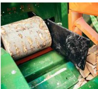
Le tronçon de grume scié est acheminé jusqu'au vérin à travers la bascule à bois à commande hydraulique. Ensuite, le vérin presse la matière à fendre contre le couteau.
