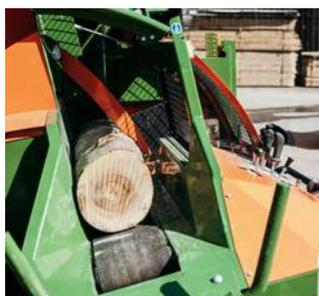
La grume est acheminée jusqu'à la lame de scie WIDIA sur une bande transporteuse, par action hydraulique, à l'aide d'un joystick. Les systèmes repose-bois, équipés de convoyeurs longitudinaux et transversaux, peuvent être combinés au cas par cas sur demande.
