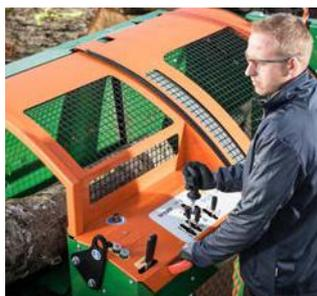
L'alimentateur de grumes à entraînement hydraulique ainsi que le dispositif de sciage et fendage sont facilement actionnés à l'aide d'un joystick d'une seule main.
