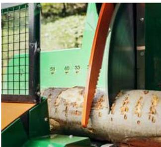
Avec un diamètre de 100 cm, la lame de scie de métal dur WIDIA raccourcit la grume d'une longueur comprise entre 20 et 50 cm, et présente une longue durée de vie. Le dispositif hydraulique de maintien du bois permet de maintenir les grumes de manière sûre.
