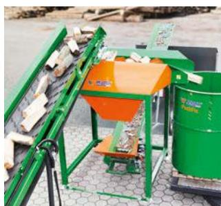
Les tapis d'évacuation transportent les bûches obtenues vers le système d'emballage souhaité. Grâce à la combinaison du système de nettoyage du bois LogFix et du système PackFix, vous obtiendrez un bois de chauffage de haute qualité et emballé proprement.
