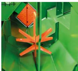
Grâce à Autospeed, le SpaltFix sélectionne automatiquement la vitesse d'avance optimale. Il coupe, fend et charge le bois en une seule opération et, ainsi, il produit à chaque fois jusqu'à 8 bûches en un temps record.
