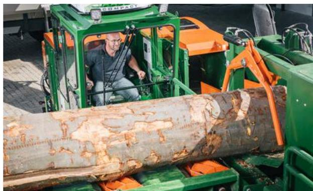
La scie à chaîne et l'unité de fendage "AutoSplit" sont commandées depuis la cabine, qui peut être chauffée et climatisée.
