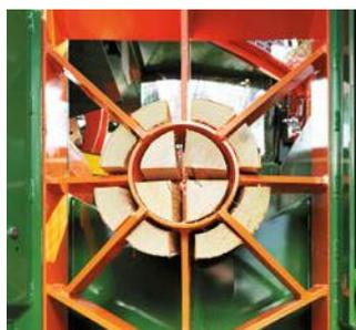
Le couteau de fendage MULTI réglable hydrauliquement garantit un résultat optimal pour tous les diamètres de grumes. La machine produit ainsi jusqu'à 18 bûches uniformes (SpaltFix K-540) en une opération.
