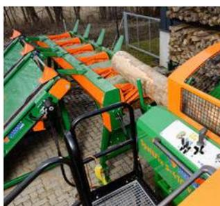
Les grumes sont introduites dans l'unité de sciage par le biais d'un tapis d'amenée performant. Les systèmes repose-bois, équipés de convoyeurs longitudinaux et transversaux, peuvent être combinés individuellement sur demande.
