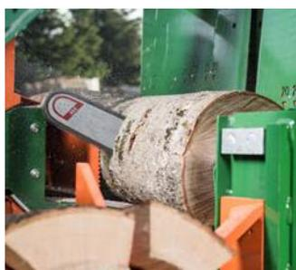
La scie à chaîne d'une longueur de 53 cm coupe les grumes à la longueur souhaitée de 20 à 50 cm. Le moteur de la scie et la pompe de lubrification de la chaîne ne nécessitent aucun entretien.
