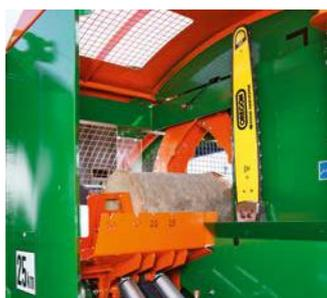
Grâce à la tension hydraulique de la chaîne et de la lame et à la double griffe hydraulique, la scie SuperCut assure une coupe sûre et rapide des grumes. Le chevalet d'évacuation hydraulique transfère les bûches vers l'unité de fendage.
