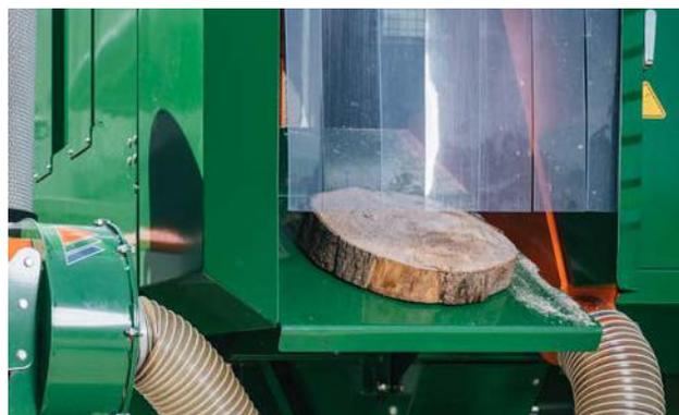
Les chutes de bois sont, le cas échéant, évacuées à travers le clapet situé à l'arrière de la machine.
