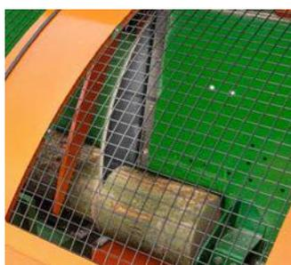
La lame de scie WIDIA en métal dur, d'un diamètre de 100 cm, se caractérise par sa longue autonomie et sa grande longévité. Le dispositif hydraulique de maintien du bois permet de maintenir les grumes de manière sûre lors du processus de coupe.
