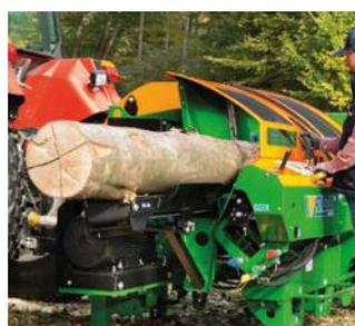
La grume est placée en position de sciage par le biais d'un tapis d'amenée. Le dispositif hydraulique de maintien du bois et la butée perméable à l'air empêchent le bois de la grume de se coincer.
