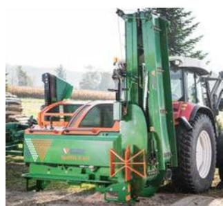
La bande de convoyage achemine les bûches à l'étape de traitement suivante. Elle peut être repliée en peu de temps à l'aide d'une manivelle et être transportée sur l'attelage trois points. Idéal pour les collectivités et les producteurs de bois de chauffage.
