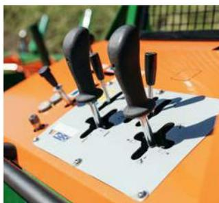
Dès que la grume a atteint le tapis d'alimentation, le processus de fendage peut être commandé en toute facilité et sécurité à travers la commande par joystick à deux main.
