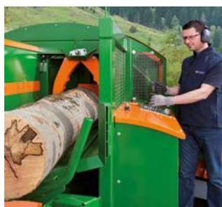
Selon la quantité de bois et le volume des grumes, différents convoyeurs longitudinaux et transversaux peuvent être combinés entre eux. De plus, le bras de centrage hydraulique permet de positionner les grumes de manière optimale.
