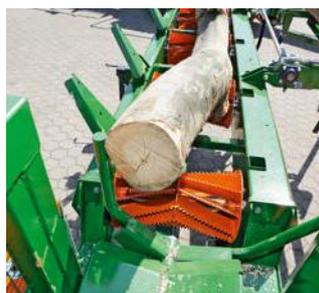
Les convoyeurs à rouleaux avec bras de centrage assurent une vitesse de traitement constante. Combinée à un dispositif hydraulique de levage des grumes (SpaltFix K-440) ou à un système de repose-bois, la production de stères est augmentée au fil des heures.
