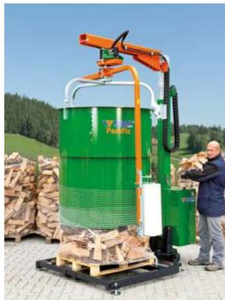
Le bras de rotation enroule en toute sécurité le tambour de remplissage et les bûches à l'aide du filet à balles rondes.
