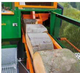
Le clapet d'évacuation hydraulique et le tapis de série permettent de transférer le bois vers l'unité de fendage de manière fluide.
