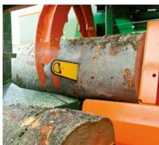
Le groupe de tête d'abattage doté d'une lame de 90 cm et d'une double pince hydraulique assure le maintien de toutes les opérations de coupage, même des grumes les plus denses.
