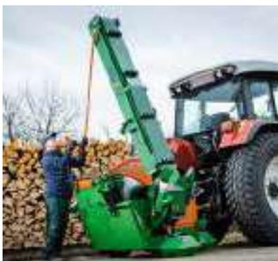
Le convoyeur peut être replié manuellement pour le transport, de façon facile et rapide.
