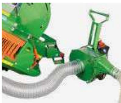
Pour un poste de travail propre, les copeaux chutant sont simplement aspirés par une ventilation performante (cf page 75).
