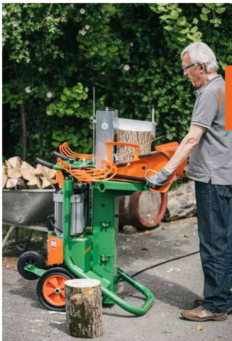
La SpaltAxt 10 possède un couteau de fendage de 26 cm de long avec lequel du bois ayant un grand diamètre (jusqu'à 40 cm) peut être traité.
