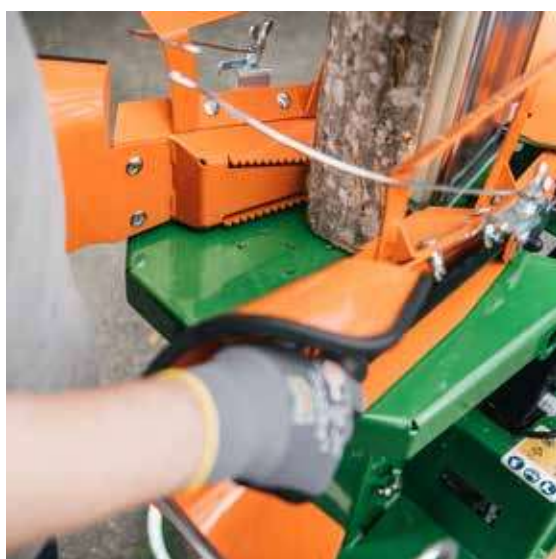
La fixation automatique du bois sur la SpaltAxt 6 permet un fendage confortable et sans danger.
