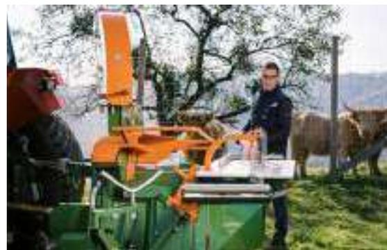
Grâce au montage de scie circulaire, vous pouvez si nécessaire couper les grumes au milieu.
