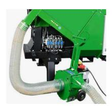
Pour un poste de travail propre, les copeaux chutant sont simplement aspirés par une ventilation performante (cf page 75).
