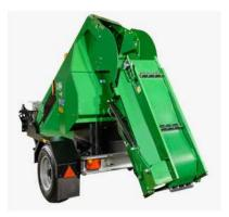
Pour un transport aisé vers le lieu d'utilisation, un châssis de tracteur longitudinal ainsi qu'un châssis routier sont disponibles dans le premier équipement.
