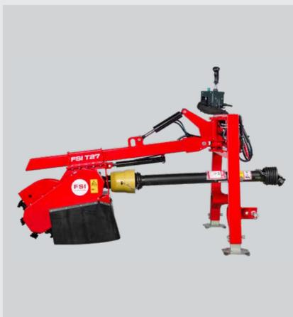
Pour les tracteurs de catégorie 1 ou 2, la FSI T27 offre une extension hydraulique et des jambes de support réglables en hauteur. Avec sa large gamme de balayage, cette rogneuse de souches est adaptée aux exigences typiques du secteur.
