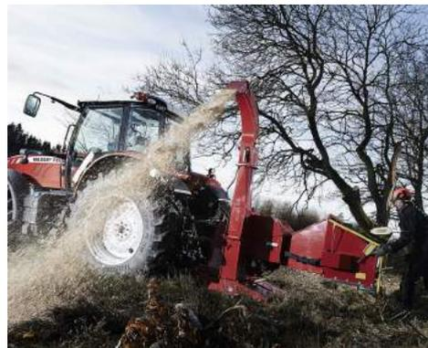
Le produit final est un copeau de bois de qualité supérieure et dont la longueur est comprise entre 4 et 13 mm. La taille des copeaux peut être ajustée hydrauliquement.
