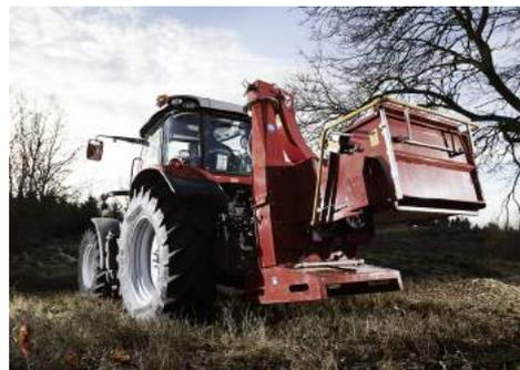
La TP 250 PTO est équipée d'un entonnoir pliant, avec la barre de commande installée en partie supérieure. L'embout d'éjection peut être pivoté (300°).
