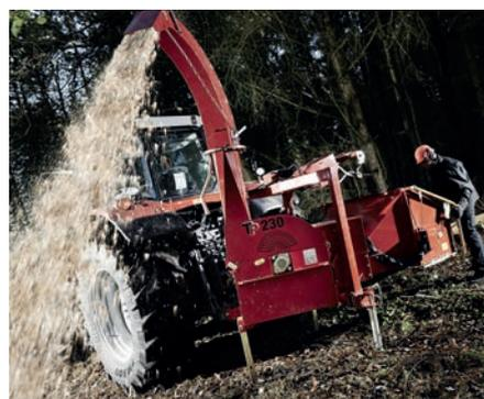
À l'instar des autres déchiqueteuses de bois TP, la TP 230 PTO est facile à entretenir ; toutes les pièces d'usure peuvent être remplacées à l'aide d'outils standard. Le verrou du disque assure une sécurité maximale lors du remplacement des lames.
