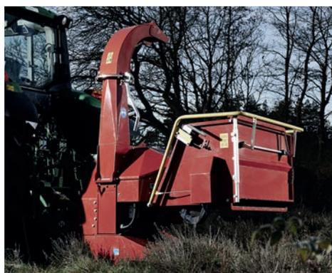
TP 200 PTO est équipée d'un entonnoir pliant, avec la barre de commande installée en partie supérieure. L'embout d'éjection peut être pivoté (300 degrés).
