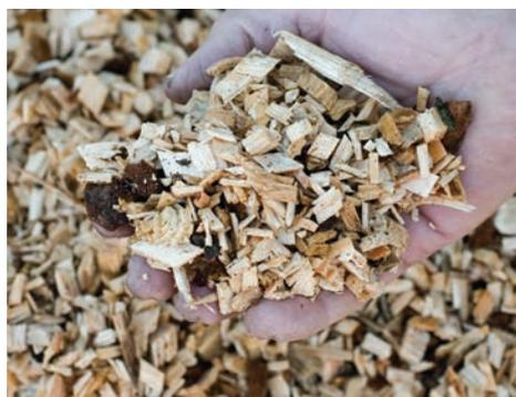
Le produit final est un copeau de bois de qualité supérieure et dont la longueur est comprise entre 4 et 10 mm. La taille des copeaux peut être ajustée hydrauliquement.
