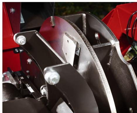
TP OPTICUT™ : le système de lames divisé garantit la pénétration constante d'une lame dans le bois. Le résultat : réduction des vibrations, meilleure stabilité de la tension exercée sur la machine, diminution de la consommation de carburant et uniformité accrue de la qualité des copeaux de bois.
