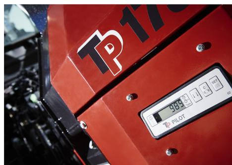
TP PILOT™ : le premier objectif du système de commande de la tension est d'éviter une surcharge du tracteur. De même, le système permet de surveiller la vitesse du disque du rotor et des rouleaux d'alimentation. Le système possède également un compteur horaire.
