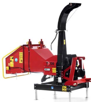
La TP 130 PTO peut donc aisément déchetage des branches fines de bois tendre - grâce à la faible distance séparant les rouleaux d'alimentation des lames, et à la position des deux contre-couteaux (vertical et horizontal).
