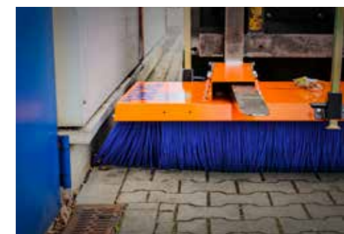
Barre de balayeuse latérale pour un balayeuse au plus près des bords
