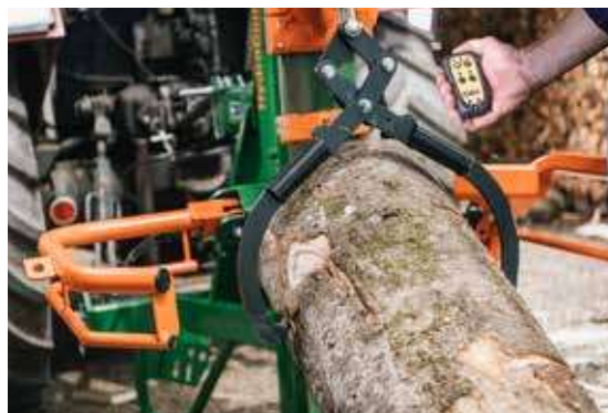
Les treuils avec pince à bois en option et la radiocommande assurent un transport facile des grumes lourdes.
