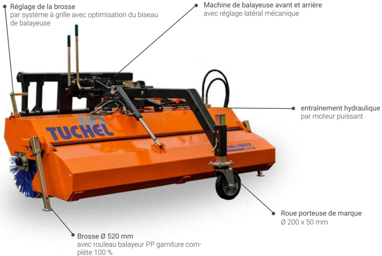
Grâce à ses différentes largeurs de travail, la machine de balayeuse avant et arrière ECO Pro peut être montée sur des tracteurs, des chargeurs de chantier et des petits chariots élévateurs.
