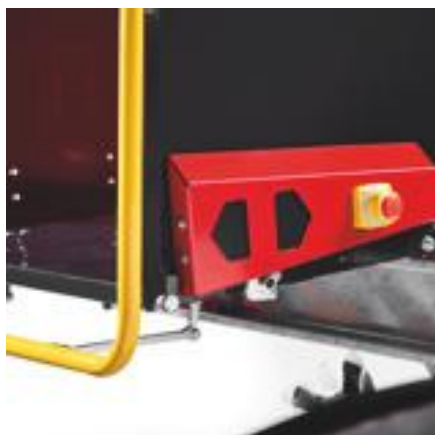
TP Easy Control met Reset – Reverse – Go-functie
