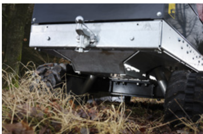
Bodemvrijheid van 250 mm, eenvoudig onderhoud en versterkte slangbescherming.
