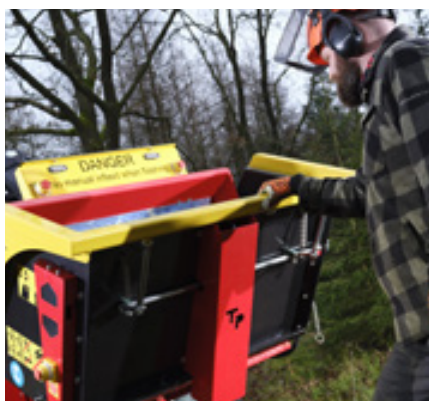
Eenvoudige bediening van de versterkte heavy-duty invoertrechter dankzij gasveer
