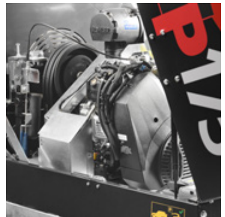
Puissant moteur Kohler EFI de 38 CH
