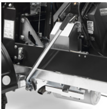
Mechanische koppeling en gas
