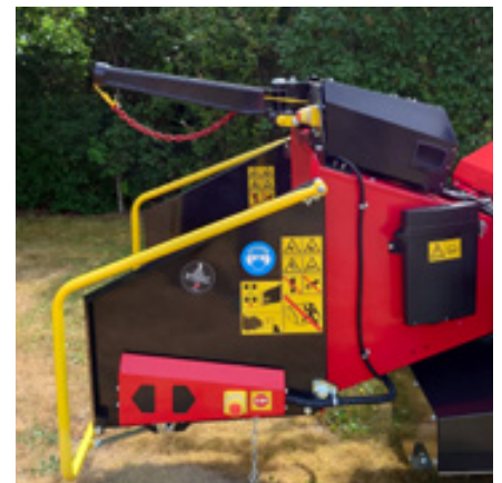
Le treuil hydraulique est une option sur tous les modèles TP 215 et les modèles à chenilles
