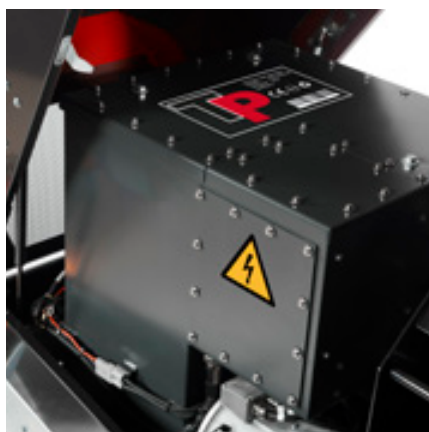
Batterie puissante de 44 kWh
