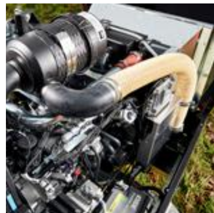
Moteur Hatz 4H50 Stage V de 55 kW
