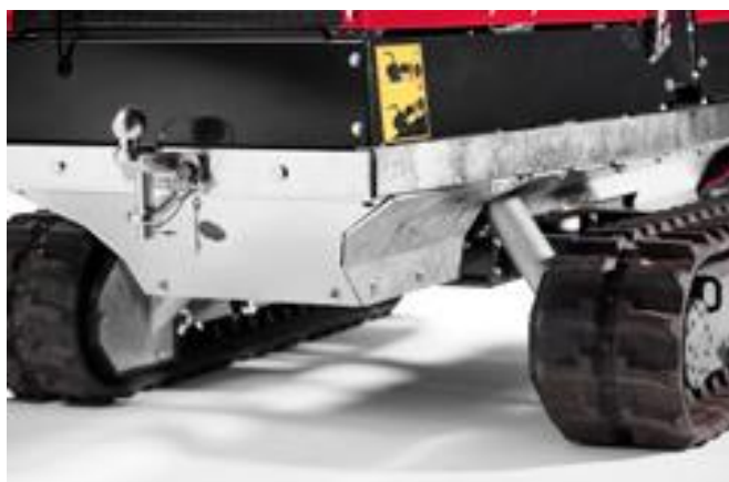
Garde au sol de 200 mm, entretien facile et protection renforcée du tuyau. Largeur de chenilles variable 115 à 135 mm
