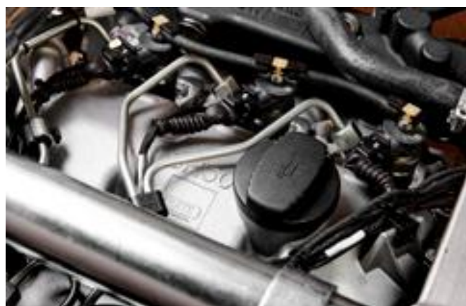
Moteur Hatz Stage V fabriqué en Allemagne avec système common rail de Bosch
