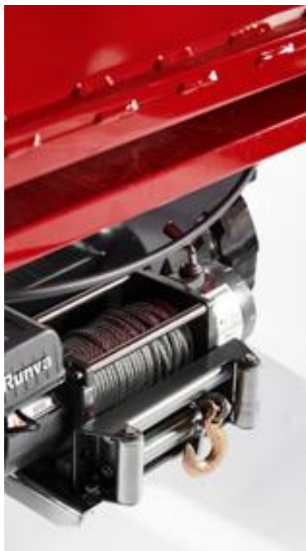
TP Winch pour gravir les terrains inclinés
