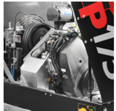
Puissant moteur Kohler EFI de 38 CH
