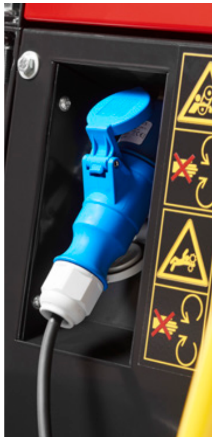
Chargeur intégré : 230V 16A 65V et câble
