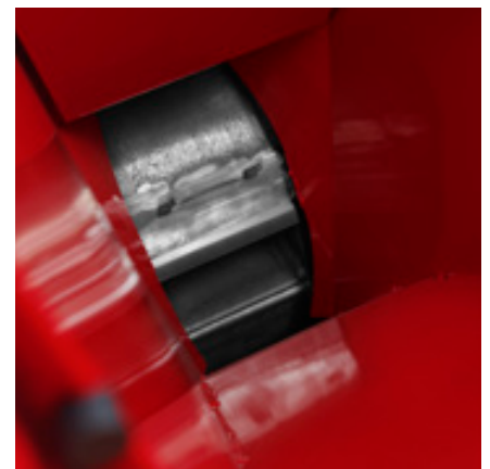
2 couteaux réversibles 1 contre-couteau réversible en acier résistant à l'usure
