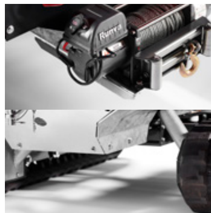
Treuil TP pour graver les terrains inclinés. Meilleure garde au sol sur le marché : 200 mm Largeur de chenilles : 1150 à 1300 mm. Protection renforcée du tuyau.
