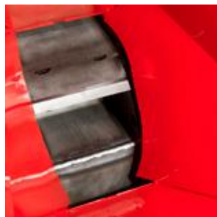
2 couteaux réversibles 1 contre-couteau réversible en acier résistant à l'usure
