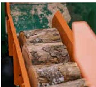
même avec des longueurs des bûches réduites. La paroi de butée sur le tapis tampon peut être réglée sur 2 niveaux pour transférer le bois en toute sécurité. « OptiSplit » optimise automatiquement la course de fendage, pour vous permettre de travailler encore plus efficacement.
