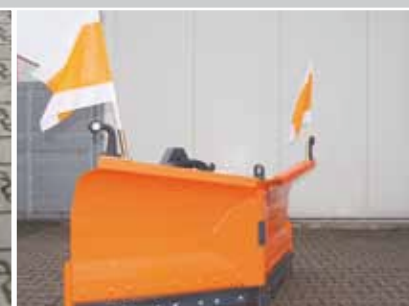
Avec équipement de signalisation; code de la route (drapeaux et portes-drapeaux, feux de position)
