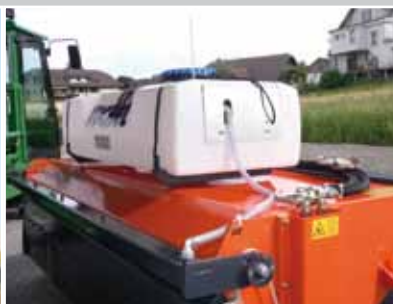
Système de pulvérisateur avec réservoir d'eau 100 / 200 litres
