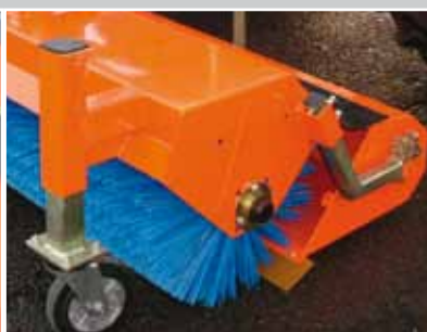
Bac collecteur avec lame racleuse en vulkollan
