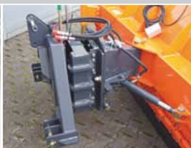
Systèmes d'attelage pour des divers véhicules-porteurs
