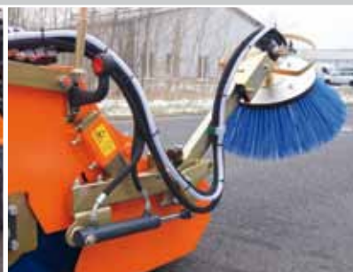
Brosse latérale hydraulique, repliable
