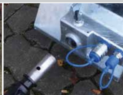
Attelage rapide et 1 fonction hydraulique double-effet standard
