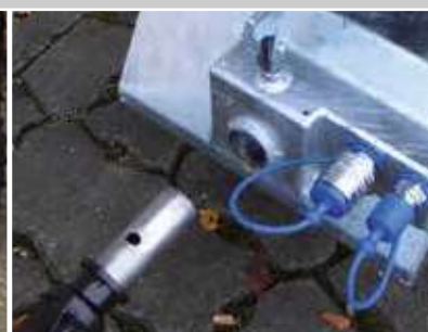
Schnellwechseinrichtung u. doppelt wirkender Hydraulikanschluss serienmäßig
