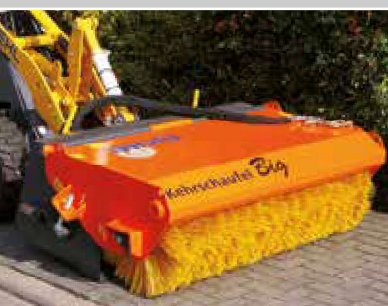
Big mit Schnellwechselrahmen für Radlader (optional)
