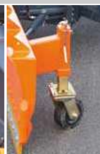
stufenlos höhenverstellbare Markenstützräder
