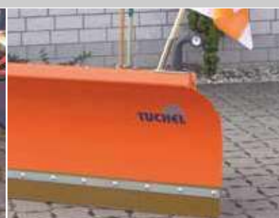
Abkantungen im seitlichen und oberen Schildbereich
