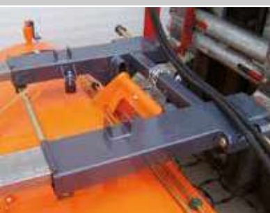
serienmäßiger 3D-Niveausgleich des Aufnahmesystems
