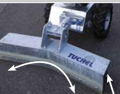
Doppellippschieber inkl. Niveaueingleich mit Randabweiser als Rolle
