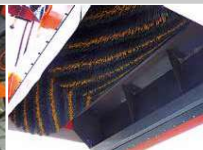
V-förmig angeordnete Spezial-Kehrwalze, für Fein- u. Grobschmutz
