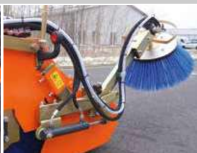
hydraulisch klappbarer Seitenkehrbesen
