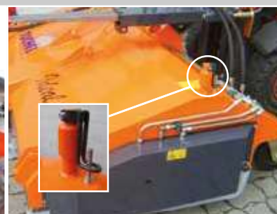
Handkurbel zum Einstellen der pendelnd aufgehängten Kehrwalze
