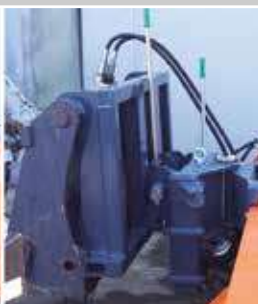
Rollenschacht mit Höhenanzeige und Pendeladapter
