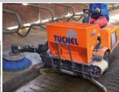
Spalten abschieben – Boxen abfegen & Einstreuen in einem Arbeitsgang
