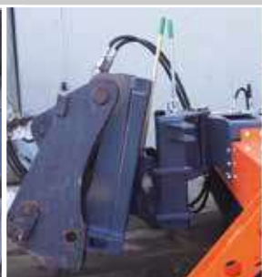
Rollenschacht mit Höhenanzeige und Pendeladapter
