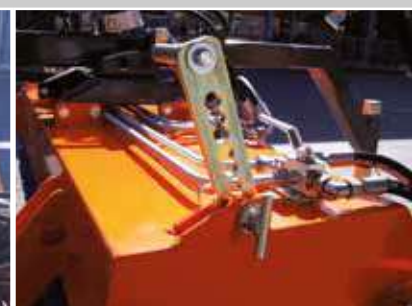
einfache Bürsteneinstellung über Rastersystem
