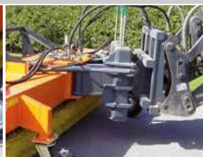
optimale Boden Anpassung durch robusten 3D-Niveaueausgleich
