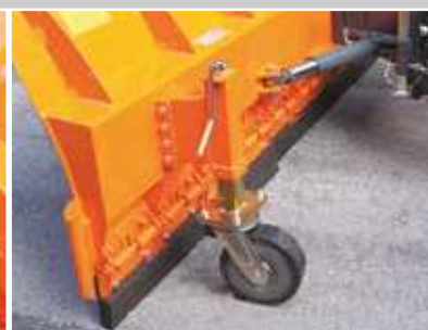
stufenlose Einstellung der Markenstützräder
