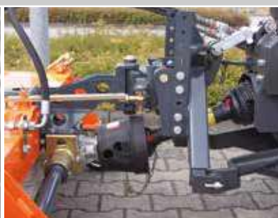
mechanischer Antrieb für Drehzahlen von 540 bis 2100 /min
