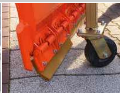
vereisungsfreie Federklappen; serienmäßig Vulkollanbesatz
