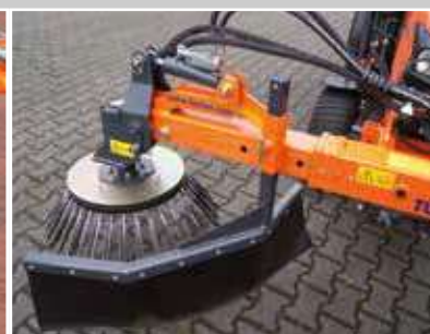
teleskopierbar und hydr. Neigungsverstellung
