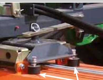
Niveaueingleich für optimale Boden Anpassung
