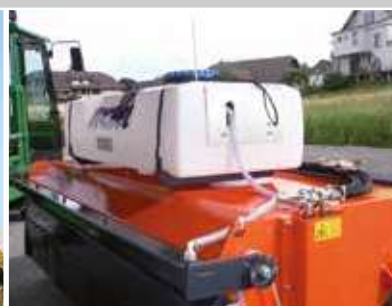
Wassersprüheinrichtung mit 100/200 Liter Wassertank
