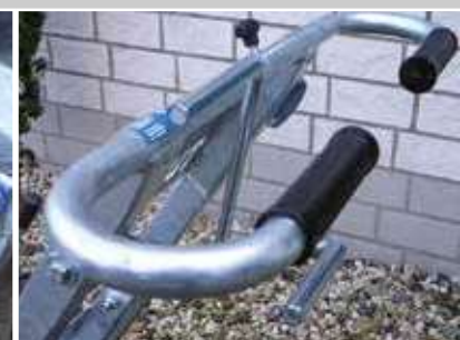
Lenker höhenverstellbar, mit Vorwärts- und Rückwärtsgang
