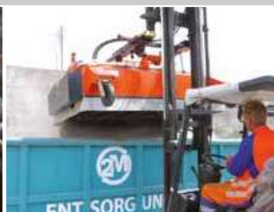
hydraulische Entleerung des Sammelbehälters, serienmäßig
