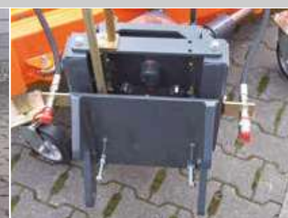
Hofladeraufnahme mit Niveaueausgleich
