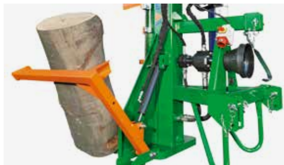
Dispositif de levage hydraulique des grumes pour plus de confort d'utilisation.
