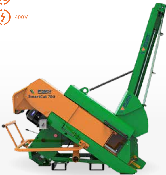
SmartCut en position de transport
