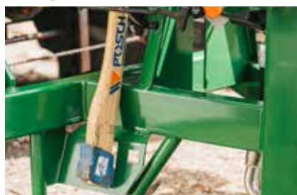
À partir de HydroCombi 16 : Support de sapi de série en position de rangement ou de transport (sapi non comprise dans la livraison).
