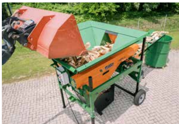
LogFix 30 : Les résidus de bois sont acheminés vers un container adapté ou un tapis d'évacuation disponible en option. Illustration avec radiocommande (RC), tapis d'évacuation hydr. rabattable (SF3 & H), trémie de remplissage (T) et châssis (F0004723).
