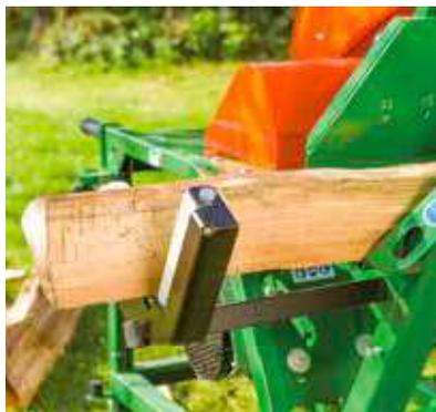
La rallonge assure un maintien sûr même pour des bûches longues. Les rouleaux permettent aux bûches de passer facilement à la coupe suivante.
