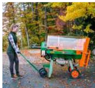
Oscar peut être transporté à la main au moyen du châssis manuel et de deux roues en caoutchouc plein.
