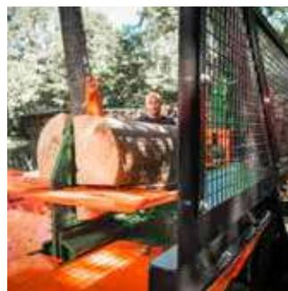
Le pack de sécurité de série (constitué de trois grilles, d'un logement pour grille, d'un repose-bois élargi et d'une soupape de sécurité), permet à plusieurs personnes de travailler sur la machine sans aucun risque.
