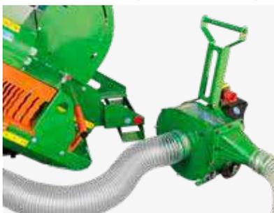
Pour un poste de travail propre, les copeaux chutant sont simplement aspirés par une ventilation performante (cf page 79).
