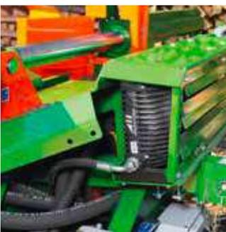
L'installation hydraulique professionnelle avec une grande pompe en fonte grise assure un cycle de fendage rapide même avec un régime de prise de force faible (illustration avec radiateur d'huile en option).
