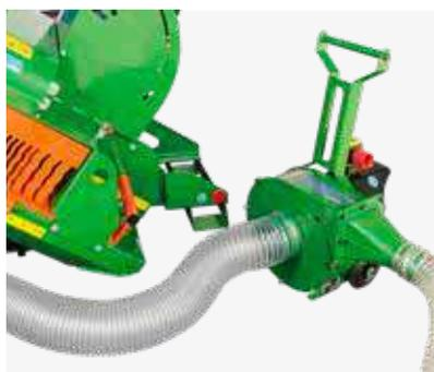
Pour un poste de travail propre, les copeaux chutant sont simplement aspirés par une ventilation performante.
