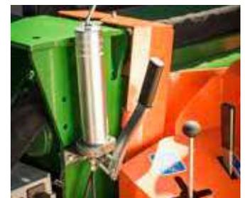
Dispositif de lubrification intégré avec pompe manuelle (disponible en option)
