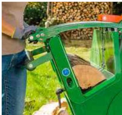
La poignée de sécurité réglable en hauteur de manière ergonomique avec protecteur intégré évitant le contact avec la lame pendant la coupe. Les rouleaux tendent pour une coupe sans se fatiguer.
