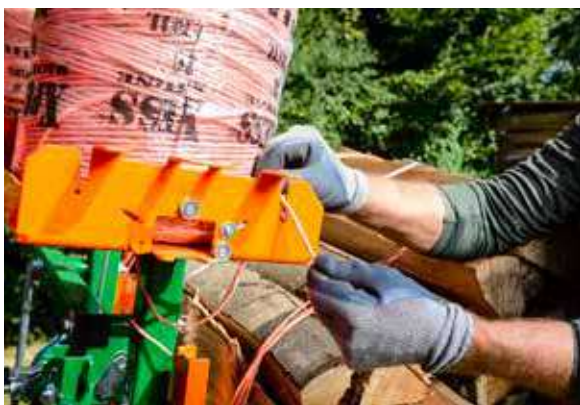
La dernière étape de travail consiste à nouer le fil et à le couper à l'aide du dispositif de coupe intégré.
