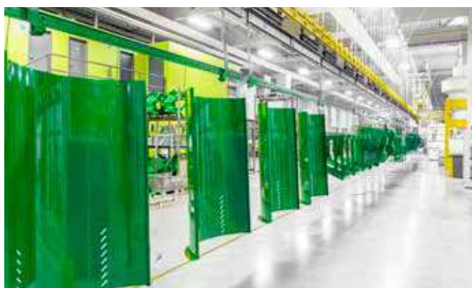
Le hall de production avec installation de revêtement par poudrage moderne protège chaque pièce de la machine pour longtemps.
