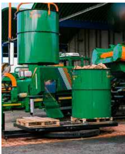
La table pivotante fait gagner du temps grâce au remplissage qui a lieu en même temps que le conditionnement.
