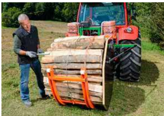
La ficelle de pressage est enroulée sur le fagot de bois.
