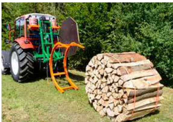
La botte ficelée peut être roulée confortablement hors du dispositif de bottelage.
