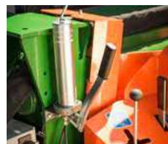
Dispositif de lubrification intégré avec pompe manuelle (disponible en option)
