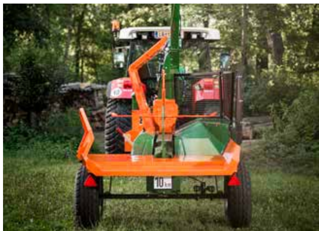
Châssis agricole longitudinal pour une utilisation mobile.
