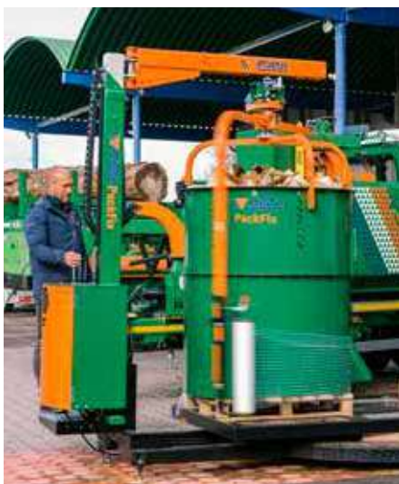
Le bras de rotation enroule en toute sécurité le tambour de remplissage et les bûches à l'aide du filet à balles rondes.
