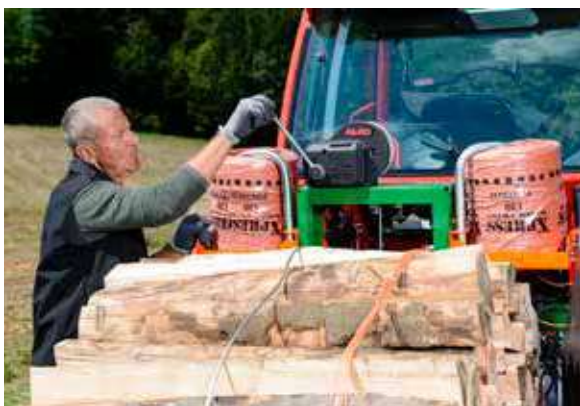
Le fagot de bois est précontraint à l'aide du treuil.
