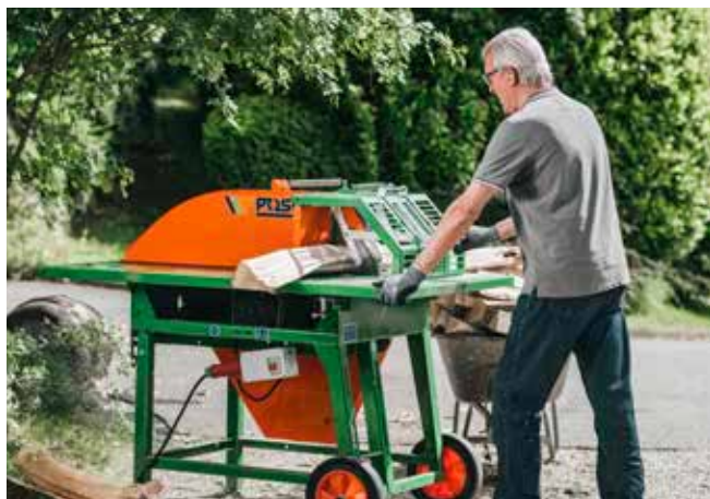
Transport facile et coupe sûre du bois de chauffage : Utilisation de la scie à table coulissante UniCut.
