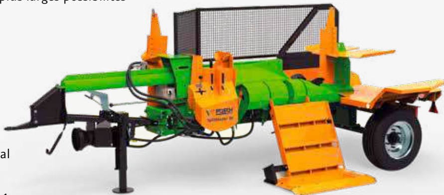
SplitMaster 30 TURBO PZG sur châssis à remorque longitudinal en position de travail
