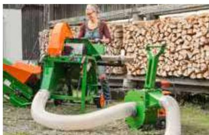
Les copeaux produits sont aspirés par un tuyau d'aspiration (Ø 15 cm) et un tuyau d'évacuation (Ø 15 cm).
