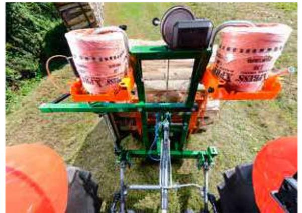
Le fagoteuse de bûches avec ficelle agricole est simple à manipuler et ne pose aucun problème à l'élimination.
