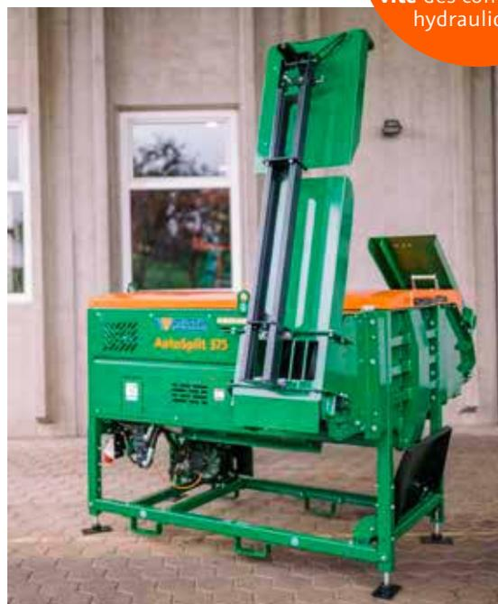
Les goulottes à bois peuvent être repliées de façon compacte pour le transport ou le stockage.
