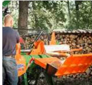
Le dispositif hydraulique de levage des bois amène aisément les grumes lourdes en position de fendage. Le nouveau canal de fendage biseauté facilite le fendage complémentaire des plus grandes bûches et rend le travail du bois particulièrement efficace. Grâce à la hauteur d'utilisation ergonomique de la table repose-bois, vous êtes en mesure de poursuivre les opérations de manière confortable et en économisant vos forces.
