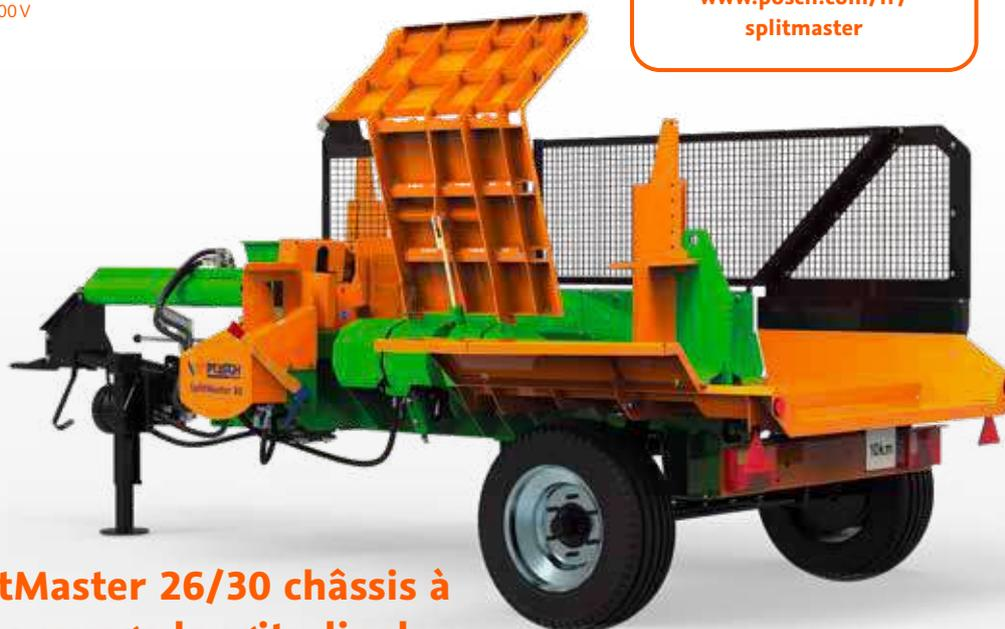
SplitMaster 30 avec châssis agricole
