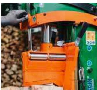
La fonction Autospeed veille à une capacité de travail maximale. Grâce à la limitation de course, le retour est réduit à la hauteur requise des grumes. L'HydroCombi est ainsi plus rapidement prêt à l'emploi.
