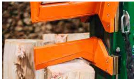
Avec le couteau de fendage en deux éléments breveté (système Fixomatic), le bois peut être fixé pendant le fendage sans devoir le maintenir.
