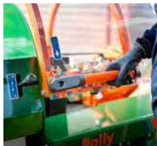
Clapet fermé et processus de fendage lancé ! Le processus de fendage démarre automatiquement lorsque vous fermez la protection en polycarbonate – sans poignée supplémentaire ni commande à deux mains. Vous pouvez garder un œil sur le canal de fendage, tout en conservant une main libre pour la bûche suivante.
