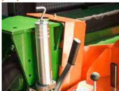
Pour un entretien optimal et rapide : Pompe manuelle disponible en option pour la lubrification de la plaque de pression. Article n° F0004130
