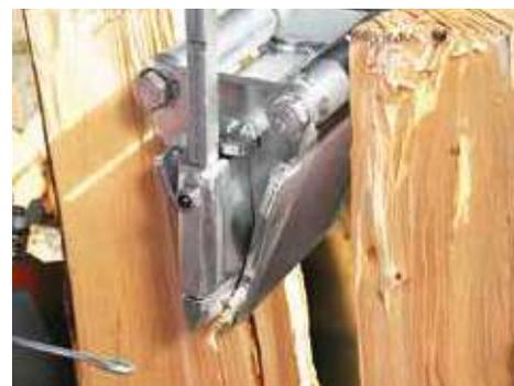
Le couteau spécial enfichable permet d'économiser des forces pendant le fendage. Le bois éclate rapidement et les rouleaux du couteau de fendage empêchent au bois fendu de rester accroché pendant la remontée. Article n° F0001654 (SpaltAxt 6), F0002544 (SpaltAxt 8) ou F0002546 (SpaltAxt 10 spécial)
