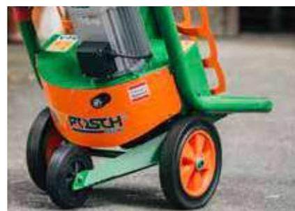
Les grandes roues en caoutchouc plein, d'un diamètre de 30 cm, et la troisième roue de support supplémentaire garantissent un transport manuel confortable.
