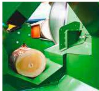
Le SpaltFix S-375 peut également être utilisé comme scie hautement performante sans couteau de fendage. Le couteau de fendage peut être démonté en quelques gestes et l'appareil produit la bûche souhaitée sur une courte durée. Par exemple, l'AutoSplit permet de transformer les bois courts en bois d'allumage.
