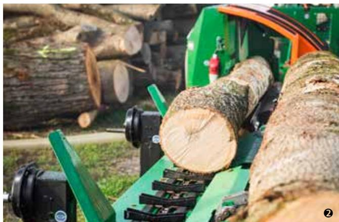
Chargement continu au moyen du système de transport des grumes, composé ① d'un convoyeur transversal et ② d'un convoyeur longitudinal.
