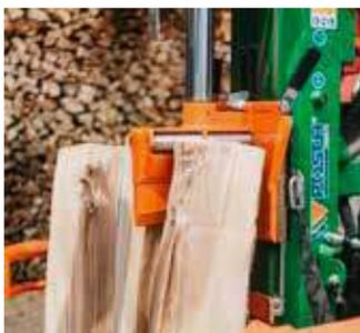
Les rouleaux intégrés empêchent que les bois tendres ne restent coincés durant le cycle de retour du vérin de fendage et assurent des opérations continues. L'acier haut de gamme et la finition précise sont le garant d'une durée de vie particulièrement longue du couteau de fendage.
