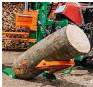
L'HydroCombi place pratiquement de lui-même les grumes lourdes dans la bonne position. Le dispositif de levage mécanique lève confortablement le bois et assure un fendage protégeant le dos et confortable. Les treuils en option facilitent encore plus les opérations.
