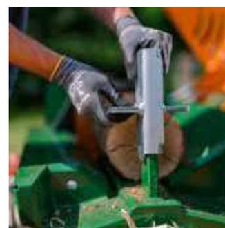
Oscar : Le coin croisé retournable 4 éclats proposé en option peut être utilisé des deux côtés pour les différents diamètres de bois.
