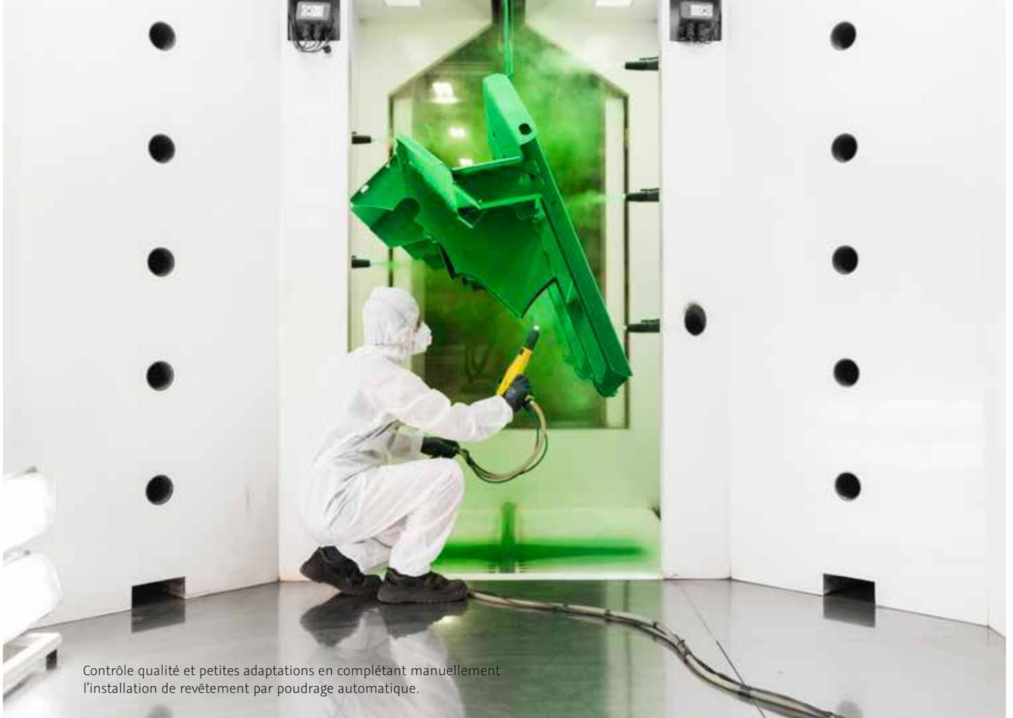
Contrôle qualité et petites adaptations en complétant manuellement l'installation de revêtement par poudrage automatique.
