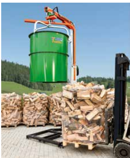
Une fois que le tambour est entièrement retiré par le haut, le filet de bois terminé peut être évacué et stocké.
