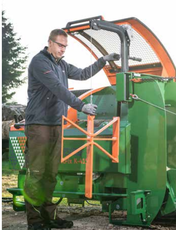
Le treuil manuel est idéal pour remplacer plus facilement le couteau de fendage. Article n° F0004317
