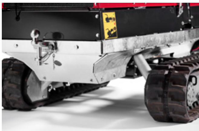
Bodemvrijheid van 200 mm, eenvoudig onderhoud en versterkte slangbescherming. Variabele breedte 1.150-1.350 mm
