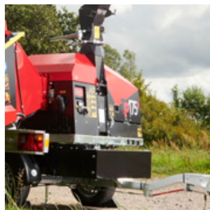
Draaiplateau 220° is optioneel (verhoogt het gewicht met 80 kg)
