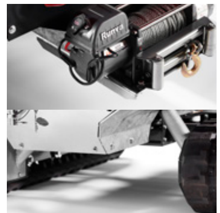
TP-lier voor steil terrein. Grootste bodemvrijheid op de markt: 200 mm breed rupsonderstel: 1150-1300 mm. Versterkte slangbescherming.
