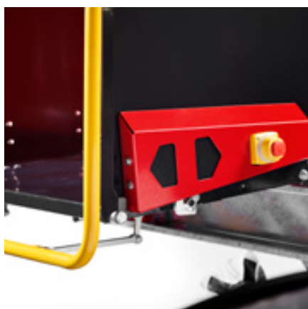
TP Easy Control met Reset – Reverse – Go-functie
