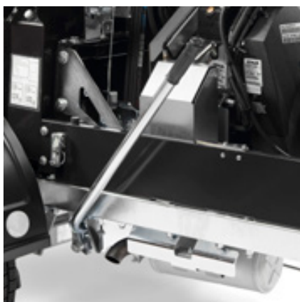
Mechanische koppeling en gas
