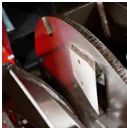
Verspringend geplaatste messen (2 stuks) die constant materiaal aangrijpen
