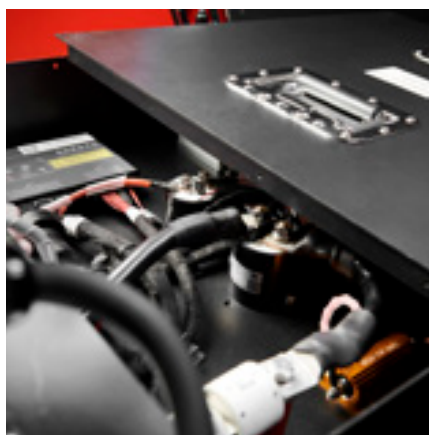
Lithiumbatterij. Mogelijkheid om te werken tijdens het opladen.
