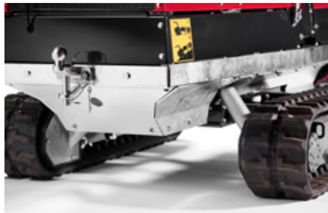
Garde au sol de 200 mm, entretien facile et protection renforcée du tuyau. Largeur de chenilles variable 115 à 135 mm
