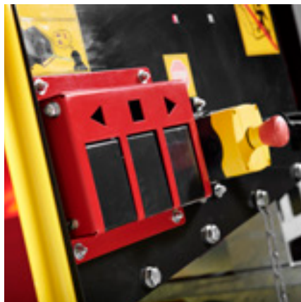
TP Easy Control: Réinitialisation – Marche arrière – Fonction Marche
