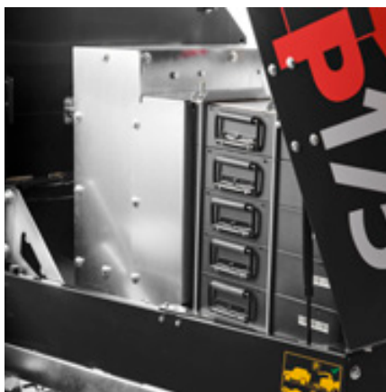
20 kWh (5 heures). La batterie au lithium (LiNiMnCoO2 65V) assure jusqu'à 5 heures d'autonomie
