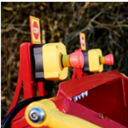
Le TP E-STOP est un standard pour la sécurité de l'opérateur
