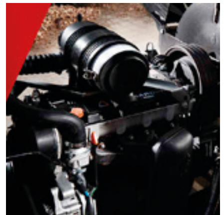
Couple élevé – moins de vibrations 4 cyl. Moteur Kohler Stage V
