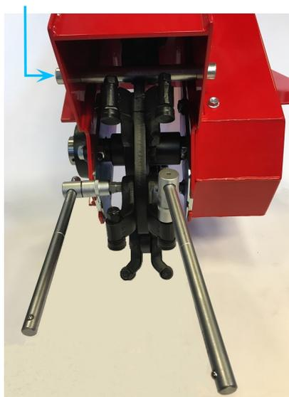
Vous pouvez retirer les dents et les supports à l'aide de l'outil fourni. L'outil est dans un sac. Si la machine dispose d'un compartiment à outils, le sac s'y trouvera.
